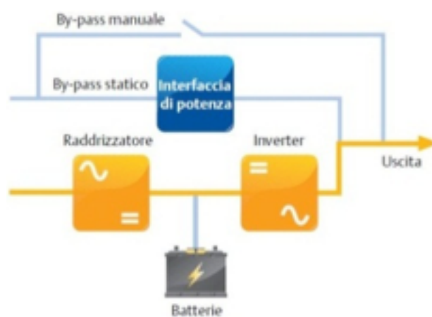
Fig. 8: UPS a doppia conversione - VFI
